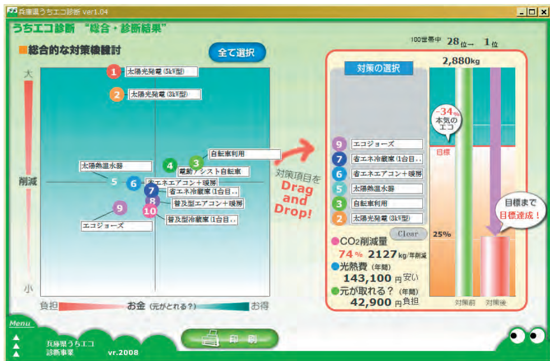
図6 大阪の標準的世帯設定で診断した結果（兵庫県うちエコ診断） ～太陽光・省エネエアコン・冷蔵庫等の導入で74%のCO 2 削減～
